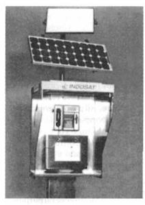
Nella versione ad energia solare l'antenna è collocata sopra la cassetta dell'apparecchio telefonico.
